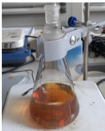
Rysunek 26. Zdjęcie koloidu nanocząstek srebra po procesie syntezy.
