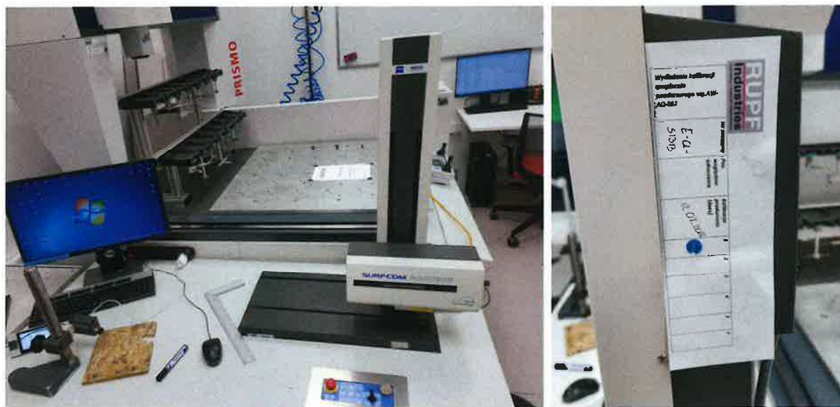
Rys. 6. Konturograf – przyrząd do analizy powierzchni i konturu materiału z aktualną kalibracją
