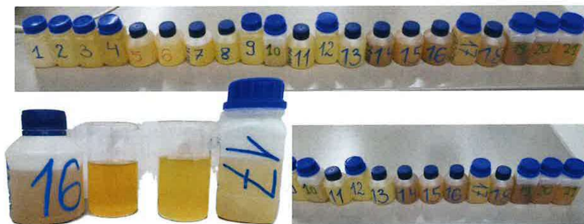
Rys. 3. Zmiana barwy emulsji w trakcie trwania testu od 1 do 21 tygodnia
