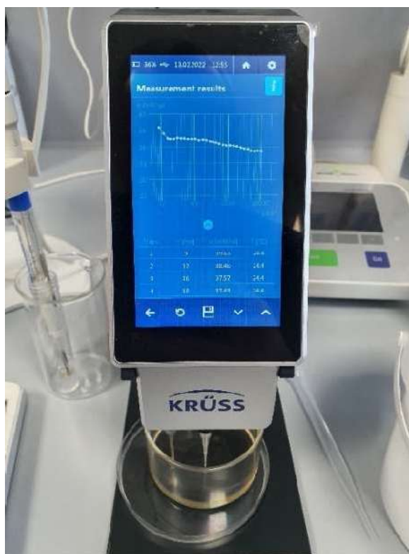
Rys. 26. Pomiar napięcia powierzchniowego próbki cieczy za pomocą aparatu BPT Mobile KRÜSS.
