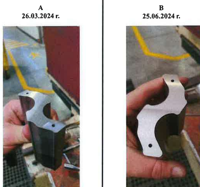
Rys. 9. Test porównawczy jakości materiału NC11LV po szlifowaniu za pomocą: (A) chłodziwa półsyntetycznego i (B) chłodziwa syntetycznego z dodatkiem nanocząstek
