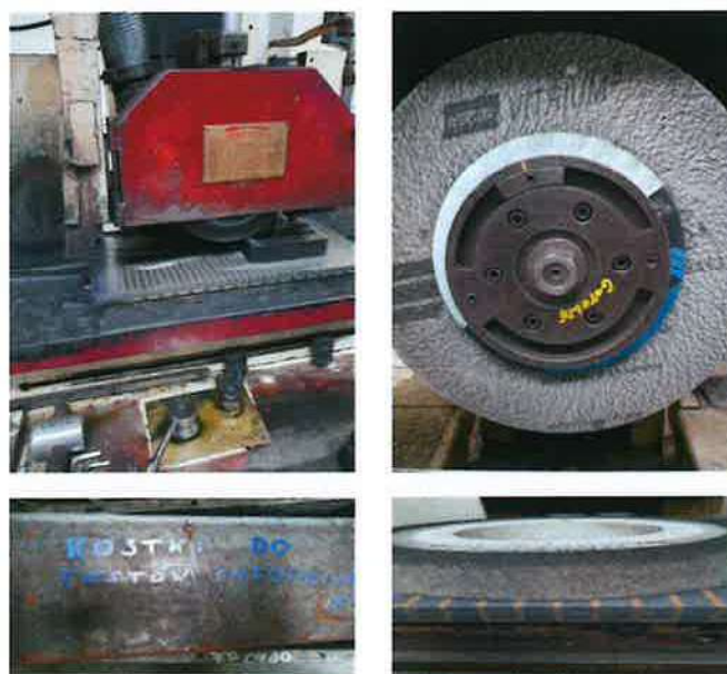
Rys. 4. Materiał referencyjny: kostka stalowa C45 oraz tarcza szlifierska NORTON 38A46 – HVBE – 35m/s
