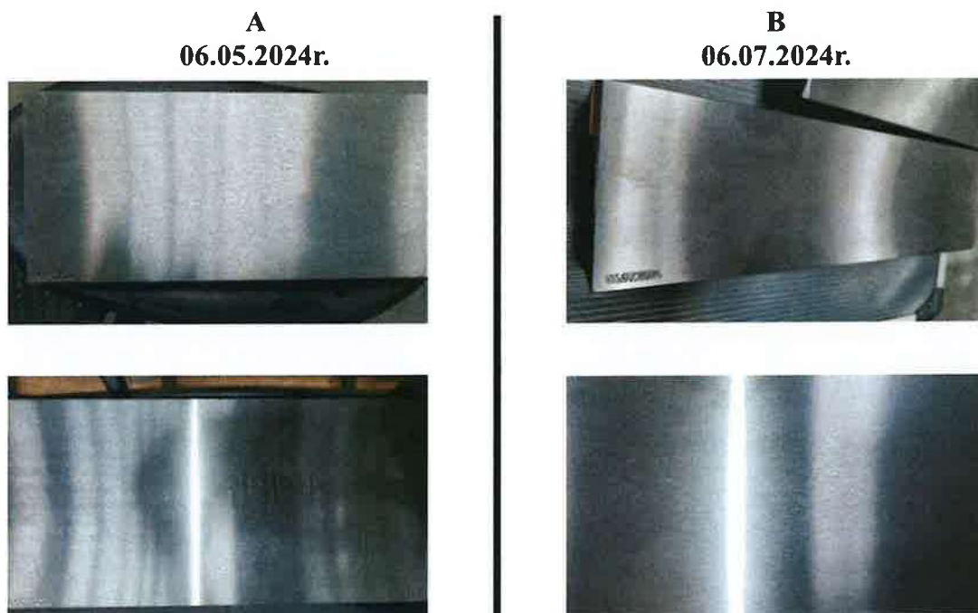
Rys. 8. Test porównawczy jakości materiału referencyjnego C45 po szlifowaniu za pomocą: a) chłodziwa syntetycznego i b) chłodziwa syntetycznego z dodatkiem nanocząstek
